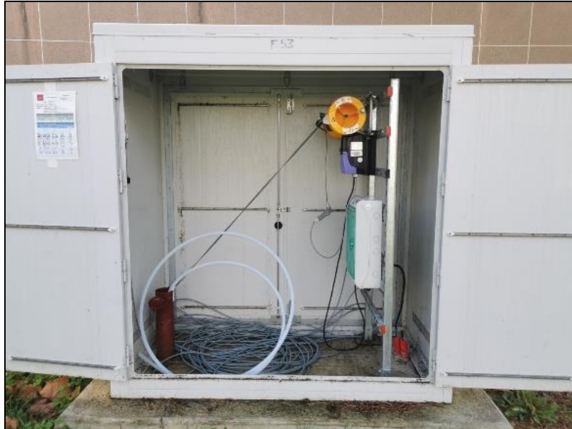
Annexe 2 : Piézomètre équipé d'un système de pompage, protégé électriquement et installé dans un abri
